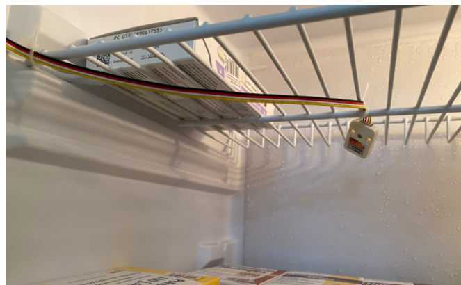
Przykład montażu czujnika w lodówce
